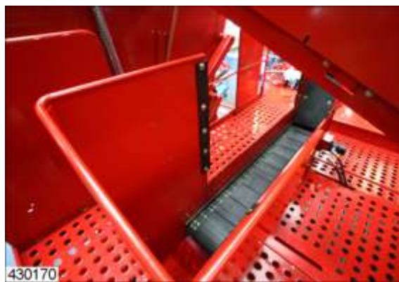
– Stortschachten en afvoerband
